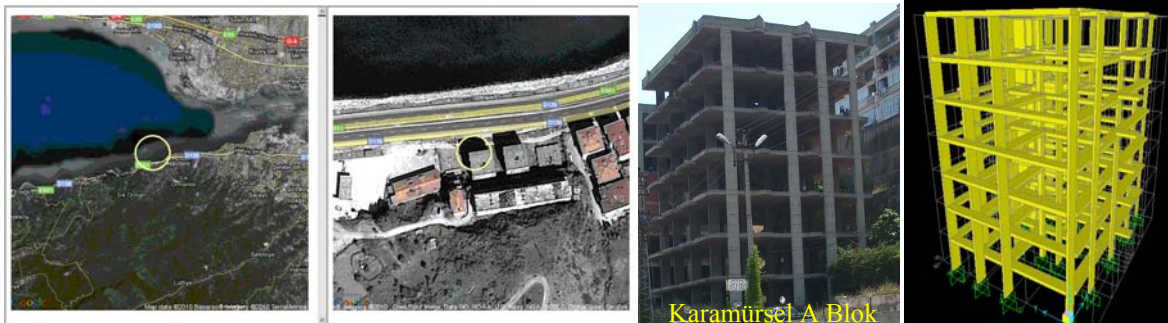
Şekil 1 İzmit körfezinde Halıderenin konumu, çalışılan binanın Halıdere'deki konumu, binanın görünüşü ve sonlu eleman nümerik modeli sırasıyla görünüyor.
