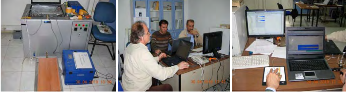
Şekil 6 İvme ölçer dinamik test düzeneği ve testi yürüten ekip, her bir referans cihazı üreticisinin ara yüzey yazılım ile izliyor, kaydediyor ve veriyi ascii formatında saklıyor.
